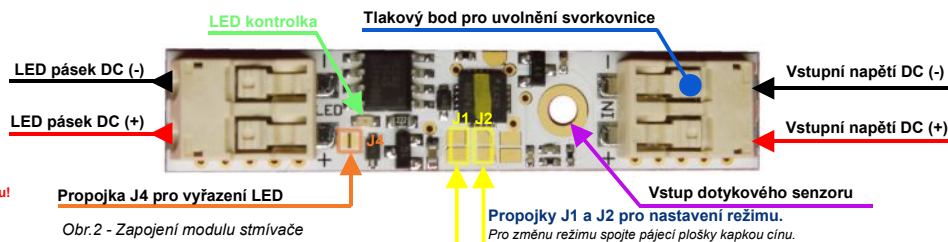
Obr. 2 - Zapojení modulu stmívače
